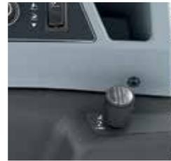
Nei trattori con tre distributori posteriori, c'è una manopola di controllo del flusso nella parte posteriore del pannello laterale. Con esso è possibile controllare il flusso del distributore marrone tra 1 a 80 l/min.
