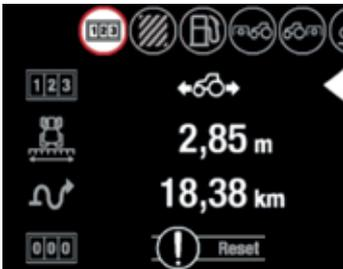
Schermata di impostazione del contatore, dove è possibile impostare il trigger la leva utilizzata per il contatore ON/ OFF, implementare la larghezza e anche reimpostare il contatore
