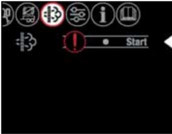
Rigenerazione attiva - usato di solito solo prima del cambio dell'olio del motore. Sarà segnalato dalla luce accesa - vedere il manuale d'uso "Risoluzione dei problemi" capitolo per i dettagli.
